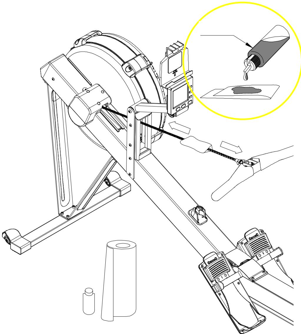
Het wordt aanbevolen om de ketting elke 50 gebruiksuren te smeren. Volg onderstaande stappen .
