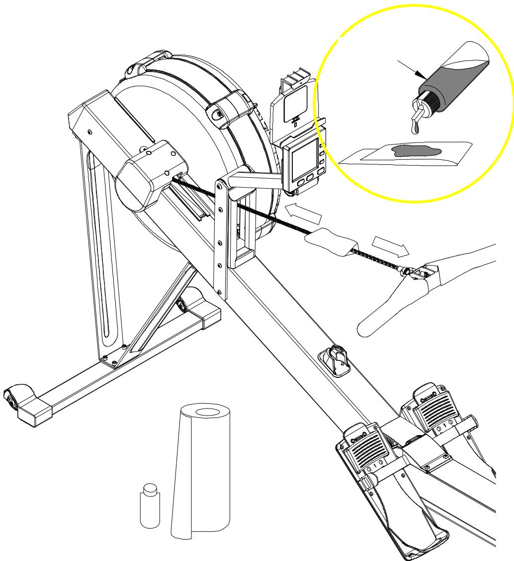
Es wird empfohlen, die Kette alle 50 Betriebsstunden zu schmieren. Folgen Sie den unteren Schritten .
